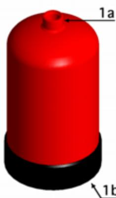
Figura 2: Serbatoio per estintore portatile
